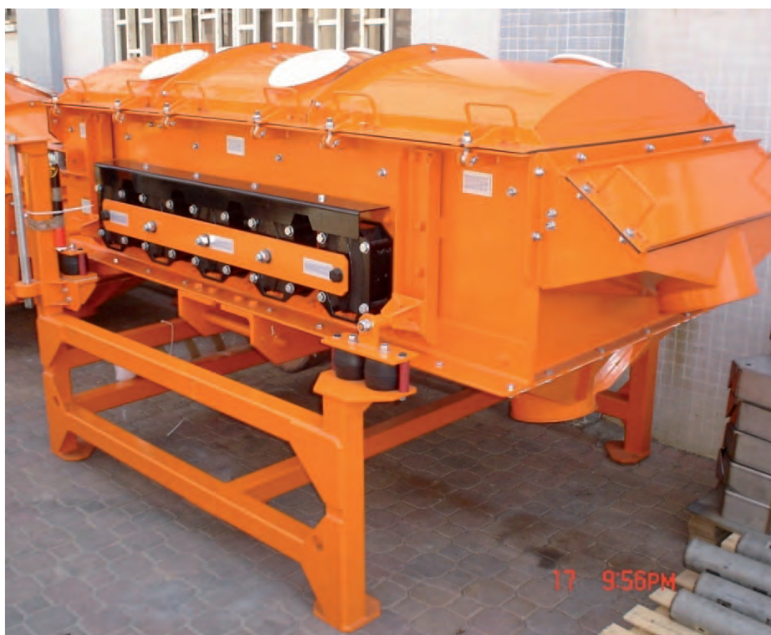
Грохот ULS 2.3x1Ext для тонкого просеивания сухого речного песка. Год запуска в эксплуатацию – 2008.
