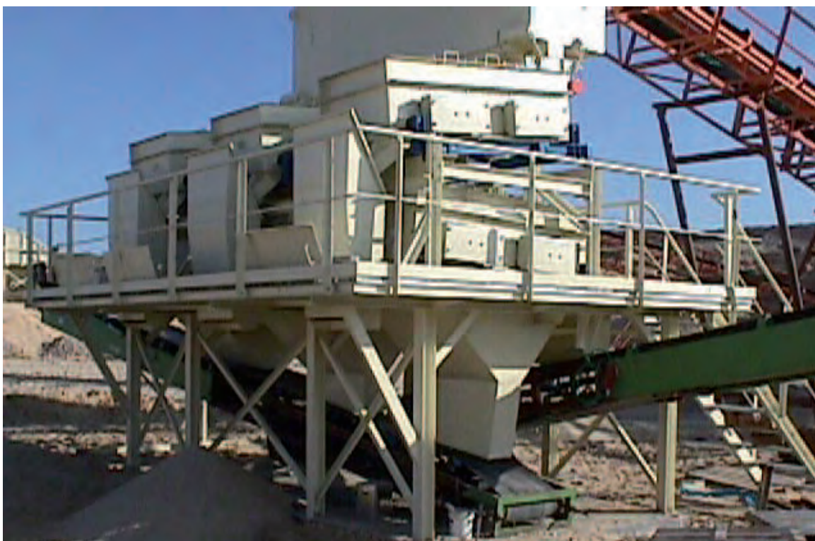
Грохота ULS 2x1 в линии получения природного стекольного песка класса 0.18-0.42 мм непосредственно в карьере. Год запуска в эксплуатацию – 2004.
