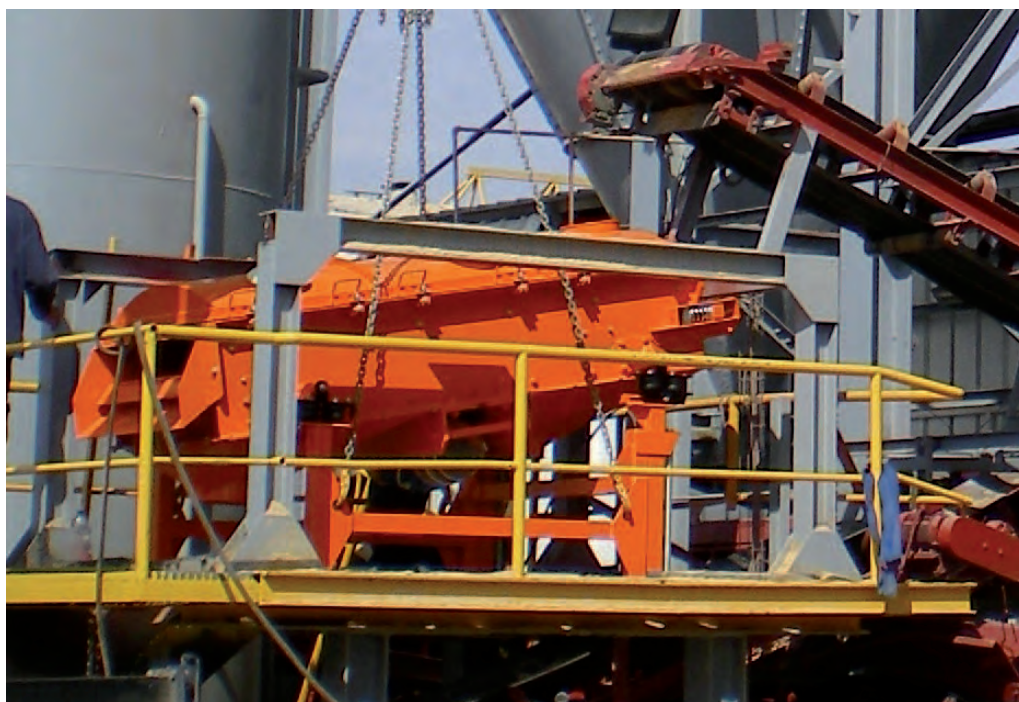
Грохот многочастотный ULS 2.3x1Int в линии просеивания влажного некондиционного песка. Год запуска в эксплуатацию – 2008.
