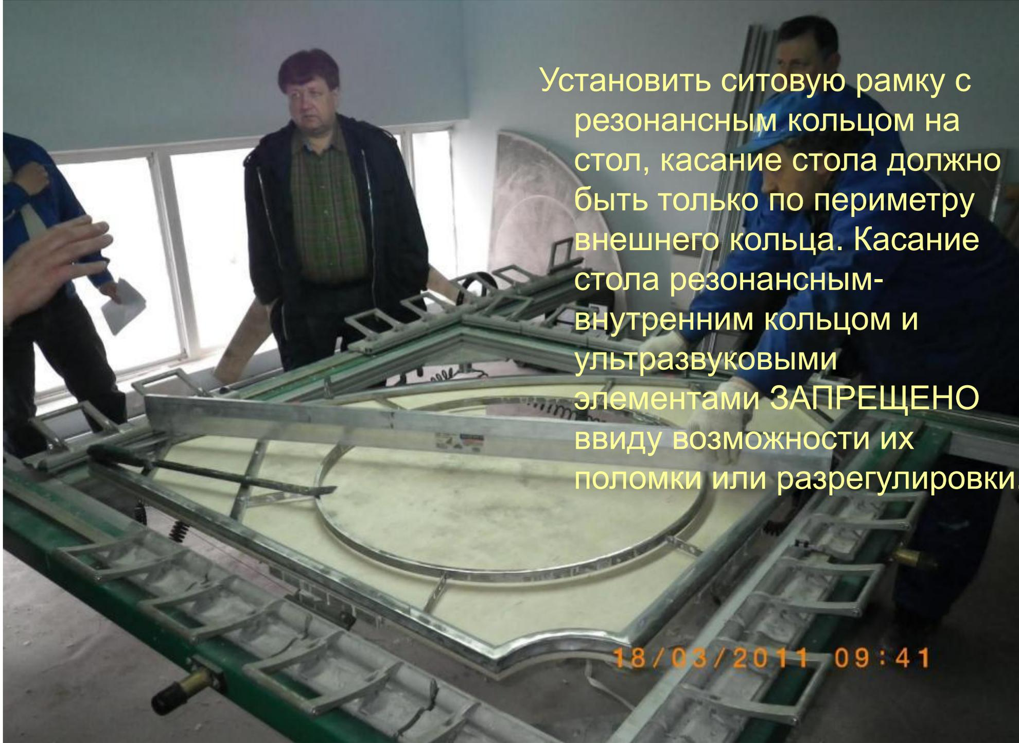
Установить ситовую рамку с резонансным кольцом на стол, касание стола должно быть только по периметру внешнего кольца. Касание стола резонансным-внутренним кольцом и ультразвуковыми элементами ЗАПРЕЩЕНО ввиду возможности их поломки или разрегулировки.
